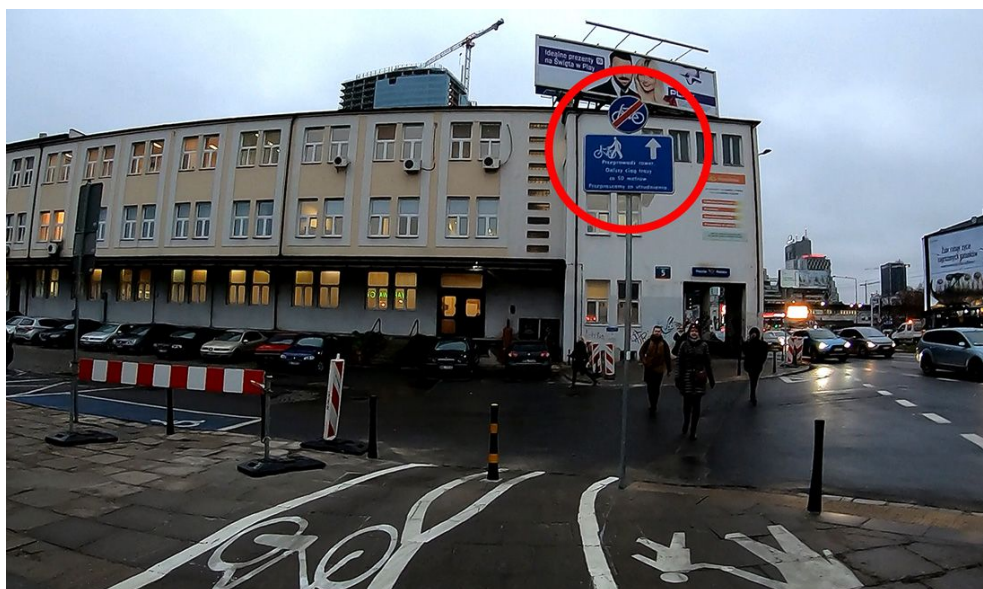
Rys. 2 i 3. Początek i koniec fragmentu substandardowej drogi dla rowerów biegnącej w kierunku północnym po zachodniej stronie ul. Towarowej z budynkiem poczty w tle. Kolorem czerwonym zaznaczono znak C-13a oraz tablicę informacyjną.
