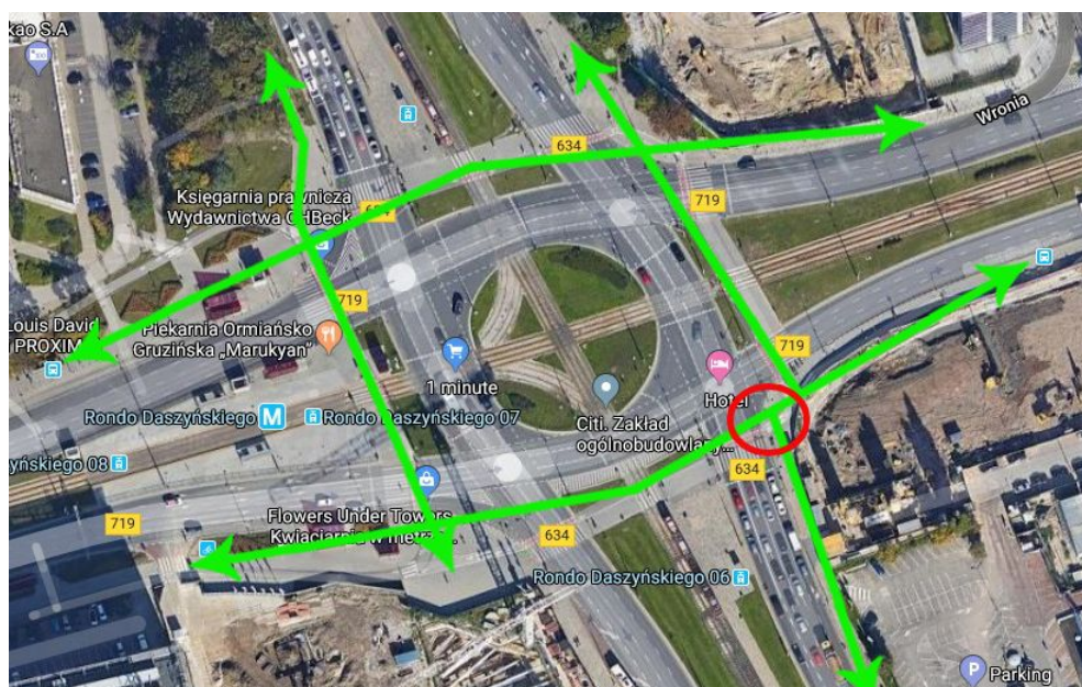
Rys. 1. Infrastruktura rowerowa na rondzie Daszyńskiego – drogi dla rowerów i przejazdy rowerowe. Kolorem czerwonym zaznaczono zamknięty przejazd na południowo-wschodnim rogu skrzyżowania.
