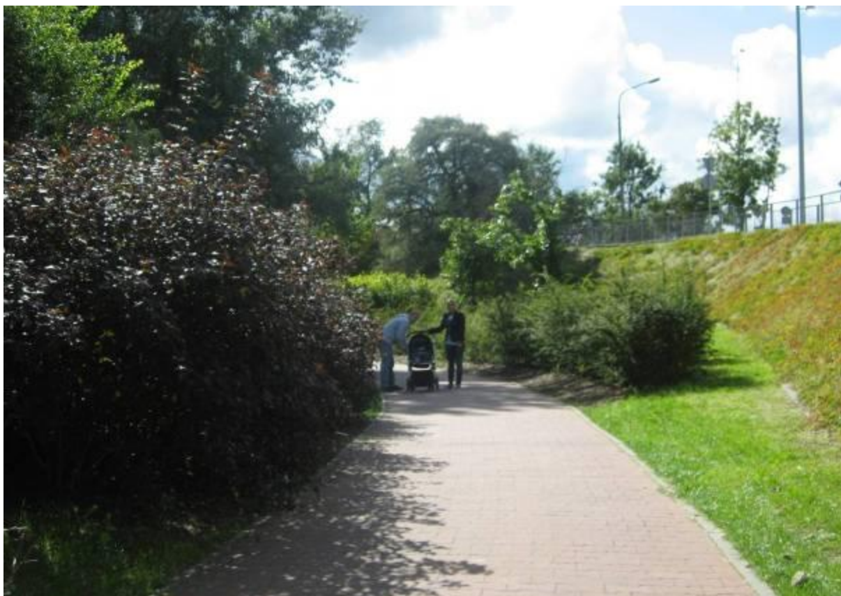
Ul. Starzyńskiego – trasa 1 i 2. Ograniczenie widoczności na łuku drogi dla rowerów i ruch pieszcy po drodze dla rowerów ze względu na to, że ścieżka znajduje się dalej od jezdni niż chodnik (u góry pomiędzy płotkami). W podobny sposób roślinność na łuku drogi dla rowerów ogranicza widoczność przy ul. Sobieskiego.
