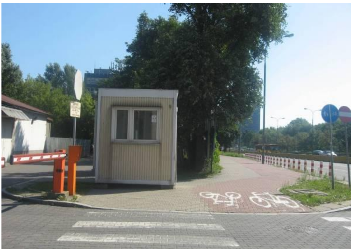
Al. Armii Ludowej pomiędzy ul. Rektorską a ul. Lekarską – sposób ustawienia budki ochrony parkingu na chodniku powoduje przeniesienie ruchu pieszego na drogę dla rowerów.
