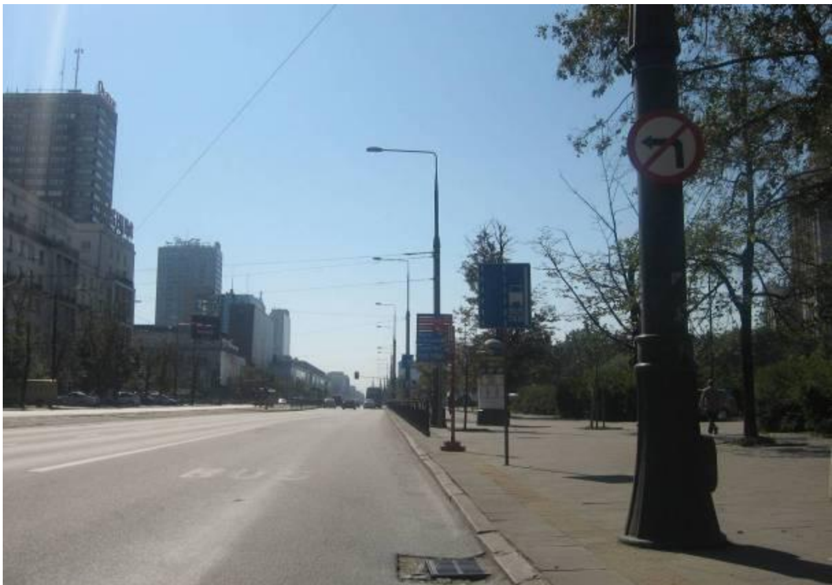
Ul. Marszałkowska – pas dla autobusów o szerokości 6m okazał się za wąski, aby dopuścić po nim ruch rowerów.
