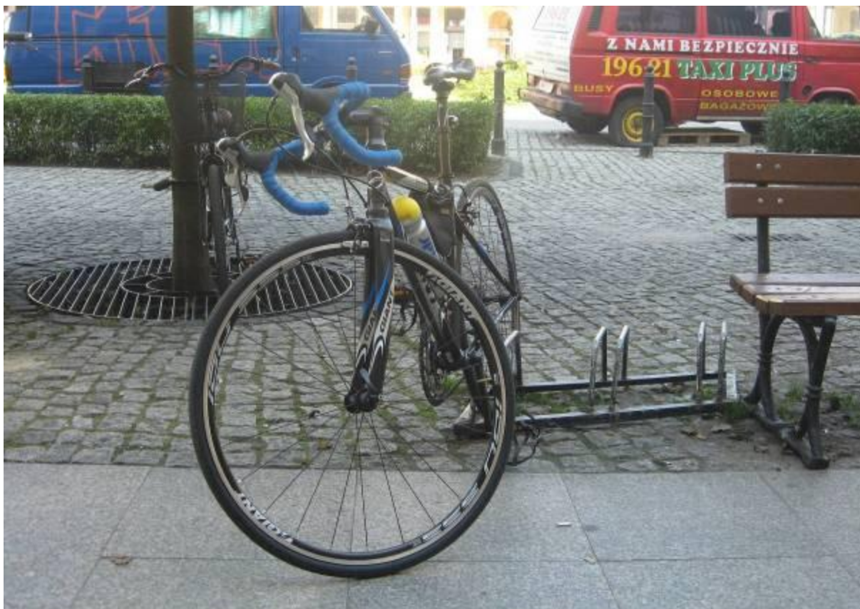
Stojak rowerowy typu „wyrwikółka” na Pl. Zbawiciela. Jak widać nie da się do niego bezpiecznie przypiąć roweru, w związku z czym niektórzy przypinają swój pojazd do drzewa.
