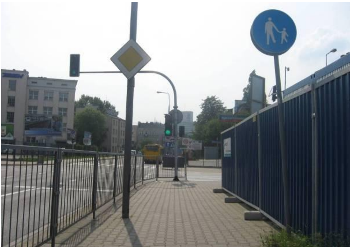
Most Świętokrzyski/ul. Wybrzeże Kościuszkowskie – trasa 2. Ciągi pieszo-rowerowe po obydwu stronach mostu urywają się w chodniku kilka metrów przed skrzyżowaniem z sygnalizacją świetlną.
