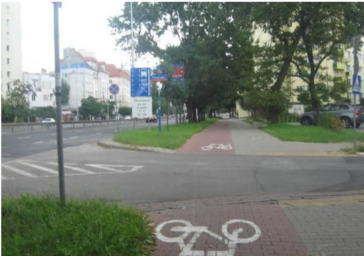
Ul. Sobieskiego/ul. Promenada – trasa 3. Brak oznakowania poziomego przejazdu rowerowego.
