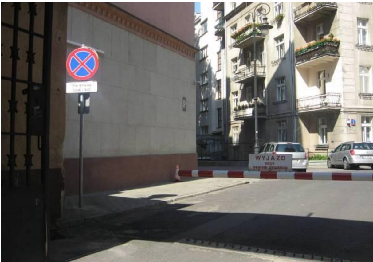
Ul. Koszykowa/ul. Św. Teresy – długość szlabanu pozwala na przejazd rowerem bez konieczności oczekiwania na jego podniesienie.
