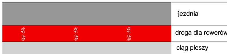
Rysunek nr 14. Schemat drogi dla rowerów nie oddzielonej od jezdni i chodnika
