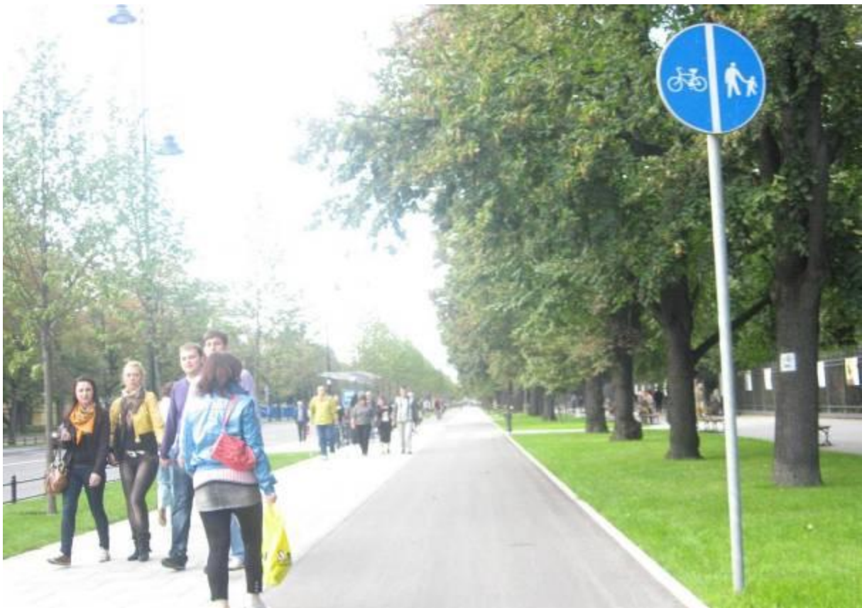
A1. Ujazdowskie/ul. Bagatela – trasa 3. Błąd w oznakowaniu pionowym (droga dla rowerów jest na znaku zamieniona miejscami z chodnikiem).
