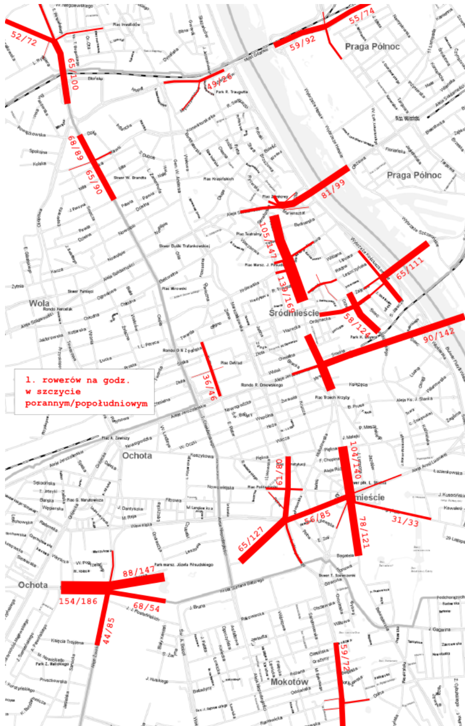
Rysunek 2. Zmierzone natężenia ruchu rowerowego. Grubość linii proporcjonalna do średniej z natężeń w szczycie porannym i popołudniowym.
